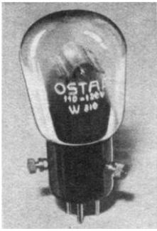
Man sieht die seitlichen Klemmen für den Heizanschluß. Dies die eine, rechts die andere — normale — Ausführungsform der neuen Röhre.
